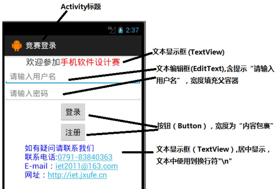
图 2- 2 文本框、编辑框和按钮使用举例的程序运行效果图
